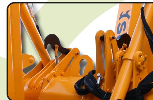
▶ Systèmes de sécurité hydrauliques pour le transport
