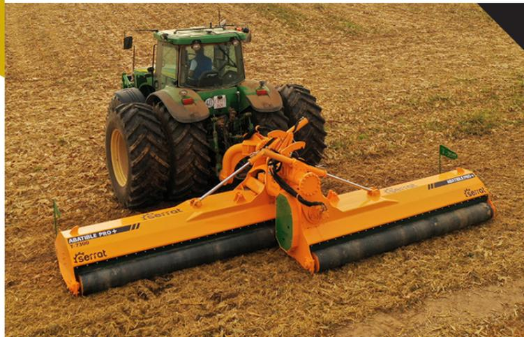
La Abatible Pro + est composée de deux broyeurs standards qui se chevauchent en mode travail. Ils sont unies par une poutre centrale possédant un système de replie hydraulique. La largeur de travail peut aller jusqu'à 6,30 m.
