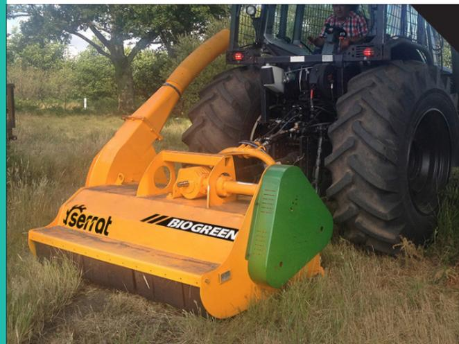
Le broyeur-récupérateur BIOGREEN permet, en un seul passage et à une vitesse constante, de couper, broyer et lancer la matière dans une remorque ou zone de stockage afin de l'évacuer du chantier.
